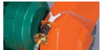
ANSCHLUSSMÖGLICHKEIT FÜR EXTERNE WASSERZUFÜHRUNG (NUR CS451 E)
