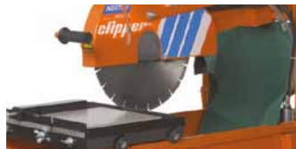
SCHUTZHAUBE BLEIBT IMMER WAAGRECHT ZUM ROLLTISCH
